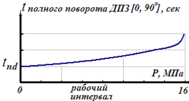
Рисунок 3 - Зависимость времени поворота ДПЗ от входного давления
